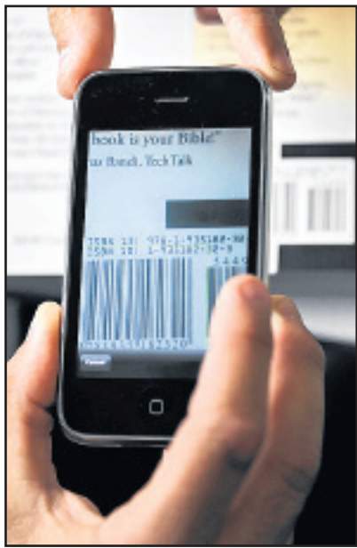
Une pression sur l'écran de l'iPhone 4 permet de lancer l'application. Il faut ensuite promener l'objectif de l'appareil photo du smartphone sur le code barre-ISBN, puis sélectionner les références engrangées sur le site web BipUp. VINCENT MURITH
